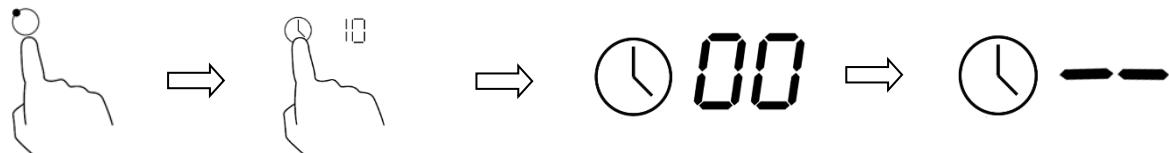
6. По истечению установленного времени выбранная варочная зона автоматически отключится. Раздастся однократный звуковой сигнал, на дисплее загорится «- -».
